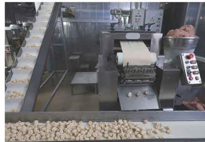
ZX-100K используется как внешний ролик и направляющая стержня в тестоделителе. Тесто пропускается через воронку в отверстие цилиндра. Направляющий стержень проталкивает тесто через отверстия вращающегося цилиндра, в котором оно заранее формируется. ZX-100K был выбран за его антиадгезивный эффект, а также за допуск к прямому контакту с пищей.
