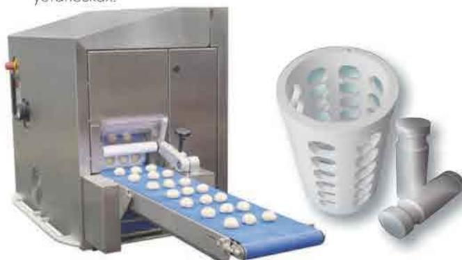
Поршень из ZX-100K позволяет точное дозирование теста на булочки. Тесто аккуратно выдавливается поршнем на лоток.
